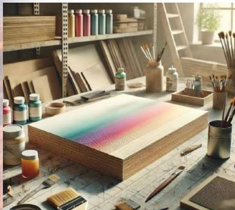
Il Medium Density Fiberboard (MDF) è un materiale ampiamente utilizzato sia nell'industria che nel mondo dell'arte per la sua versatilità e stabilità. Creato a partire da fibre di legno sminuzzate e compresse insieme a resine adesive, l'MDF si distingue per la sua superficie liscia e uniforme, che lo rende ideale per una varietà di applicazioni artistiche.
